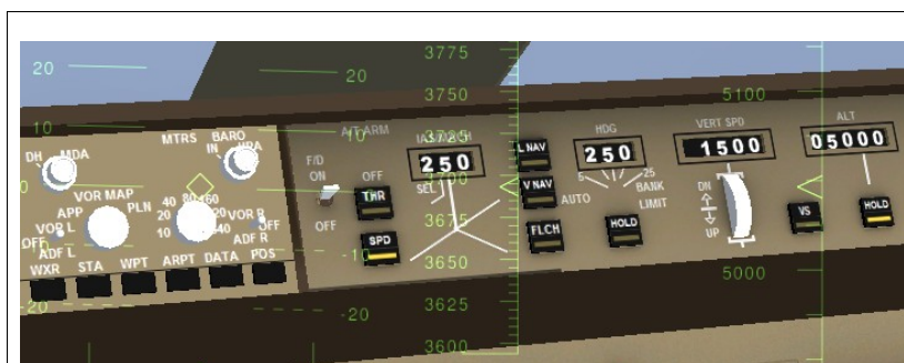
Abbildung 6: Autopilot-Einstellungen nach Erreichen der Wegpunkt-Höhe (ALT aktiviert)
